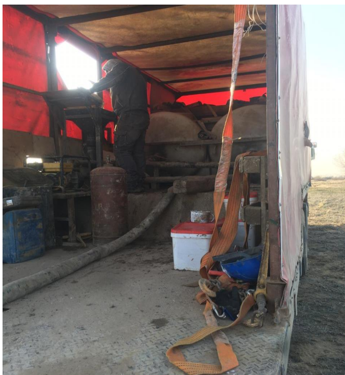
Сурет А.2 – бұрғылау ерітіндісін дайындау барысы
