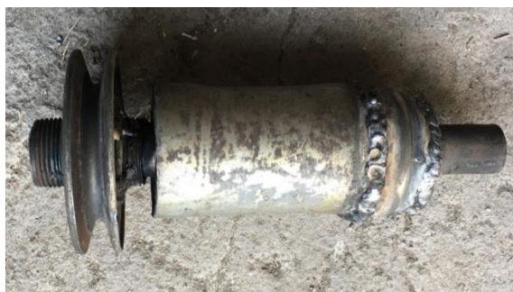
4.7 Сурет – Қолдан жасалған вертлюг
