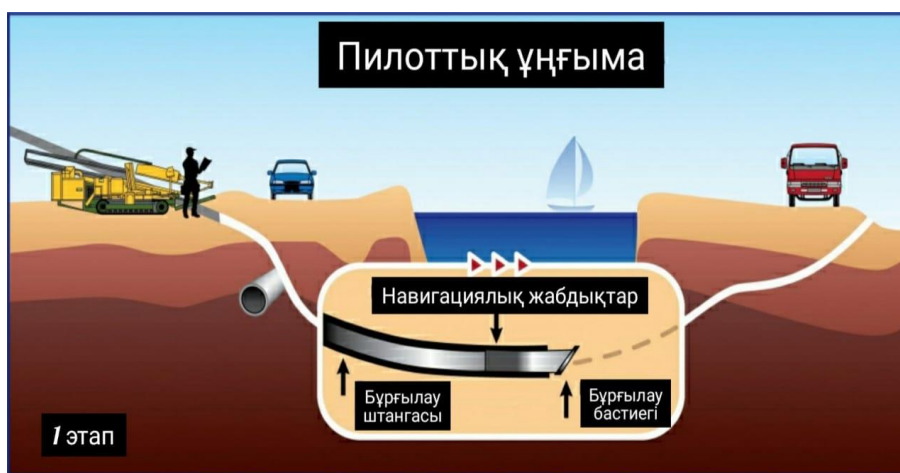
1.1 Сурет – Пилоттық ұңғыманы бұрғылау
